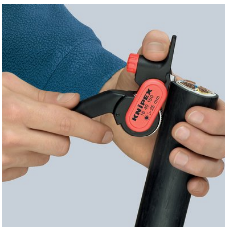
a szerszám felrakása hosszvágáshoz
